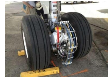
Accionamiento eléctrico en Airbus A320
