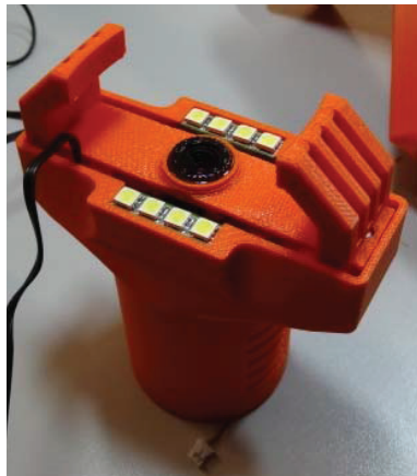
Fig. 3. Detalle de la pinza del robot cartesiano.
