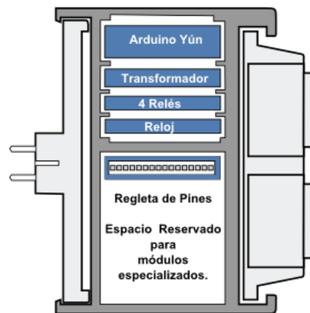
Figura 4 Diagrama general de Smartplug
