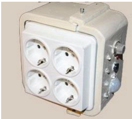
Figura 8 Smartplug módulo de alarma: en la parte derecho se encuentran situados el sensor de gas y el de presencia.
