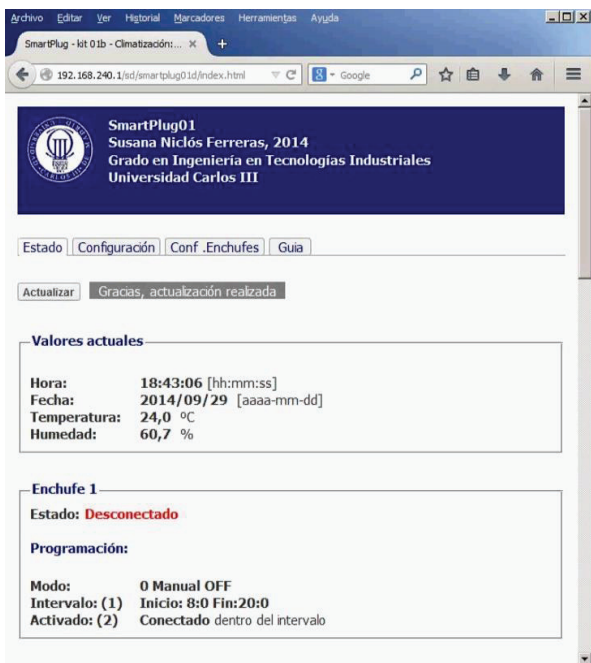
Figura 7 Ejemplo de página web para programación por temperatura en el módulo ambiental
