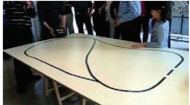
Figura 1: Circuito que los robots deben recorrer y salir del mismo, detectando las discontinuidades mostradas
