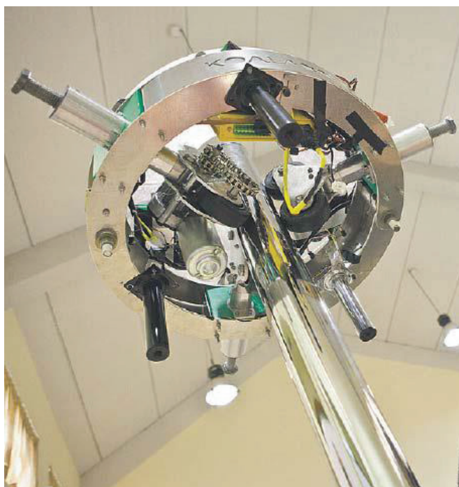
Figura: 7 Vista inferior del KoalaBot, en la que se pueden apreciar distintas partes del mismo
