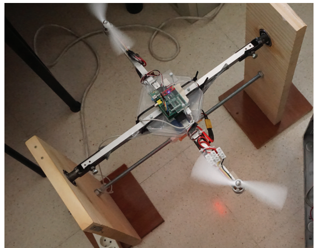
Fig. 5. Prototipo construido montado en un banco de pruebas, que permite ajustar los parámetros de los reguladores para cada eje. En el centro se observan los módulos de sensado y la plataforma Raspberry Pi.
