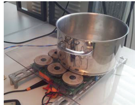
Fig. 1. Prototipo del multi-inversor resonante serie calentando un recipiente.
