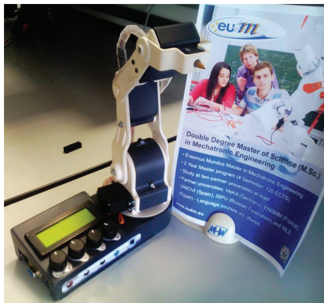
Figura 2: Brazo robótico equipado con rotulador, capaz de escribir o dibujar mensajes y figuras sencillas
