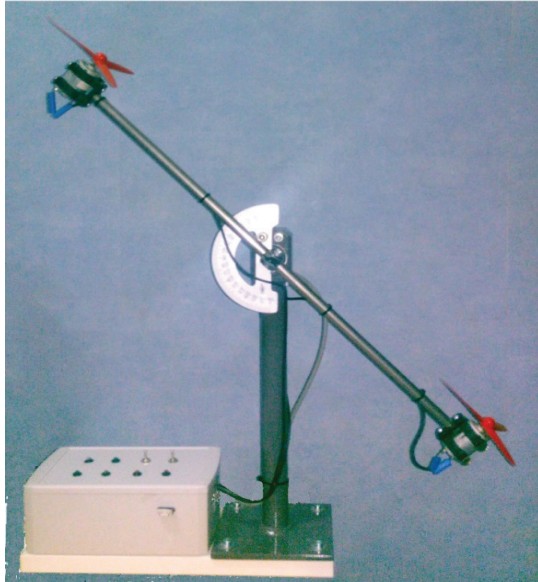
Fig. 1. Sistema físico a controlar formado por la barra giratoria con 2 motores con hélice en sus extremos.
