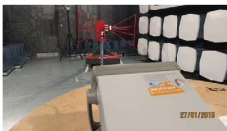
Fig. 16 Cámara semianecoica de pre-certificación
